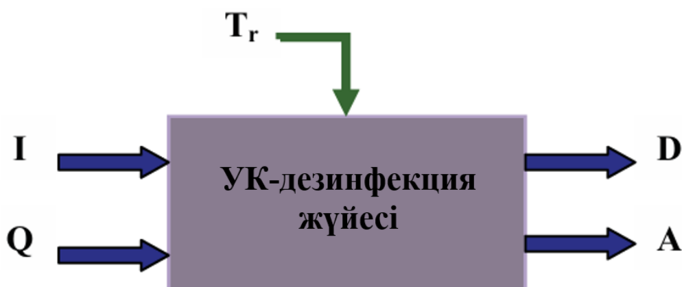
2.1.3 - сурет – Дезинфекция жүйесінің статикалық моделі: I – ультракүлгін сәуле қарқындылығы, Q – кіріс ағын жылдамдығы, D – ультракүлгін сәулесінің дозасы, A – бактериялық жойылу дәрежесі.
